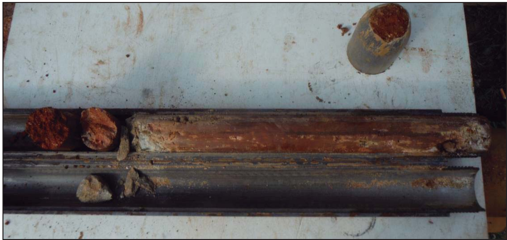
Assaig SPT realitzat a la capa A.
